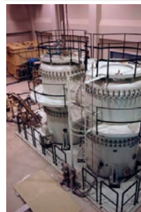
高圧タンクとイオン加速器 (JEM-ARM-1300)
